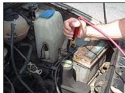
Conecte un extremo del cable rojo a la terminal (+) de la batería descargada.
