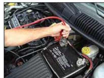
Conecte el otro extremo a la terminal positiva (+) de la batería en buen estado.
